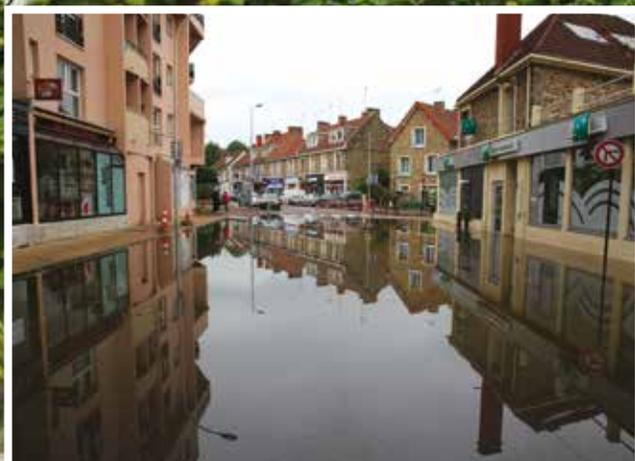
*Carrefour des rues de Chatillon et Argeliès : du fait de la pression de l'eau, une canalisation a été endommagée et la chaussée s'est légèrement affaissée.*
